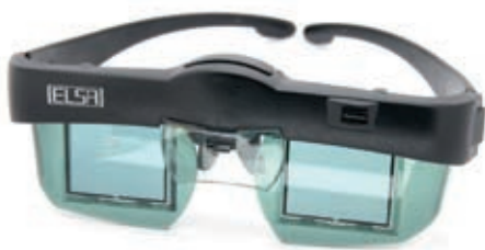
Laut Experten sieht so die Zukunft des 3D Fernsehens aus: Eine Shutterbrille mit eingebauten LCD-Schirmen und eigener Stromversorgung
